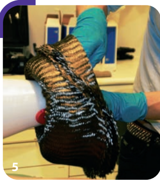
Wij leggen diverse lagen materiaal over de liner
